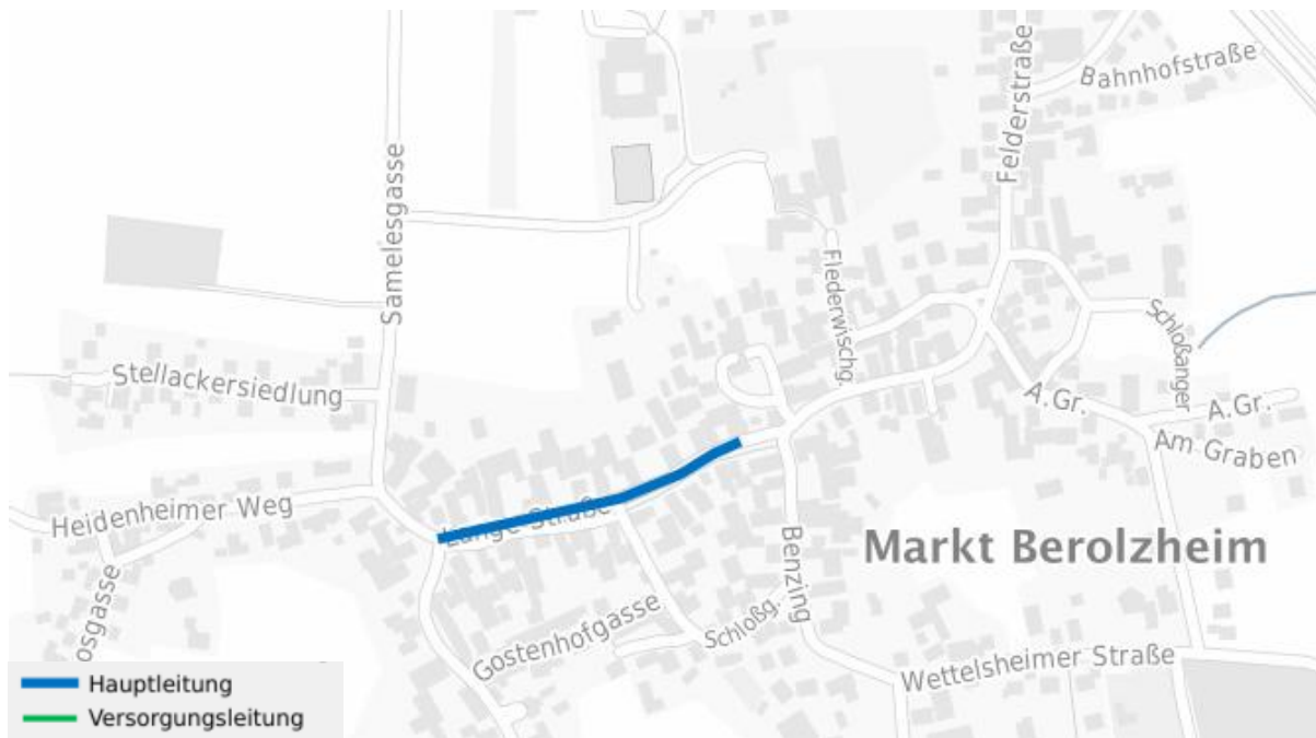
Abbildung 53: Möglicher Wärmenetzverlauf Ortskern
