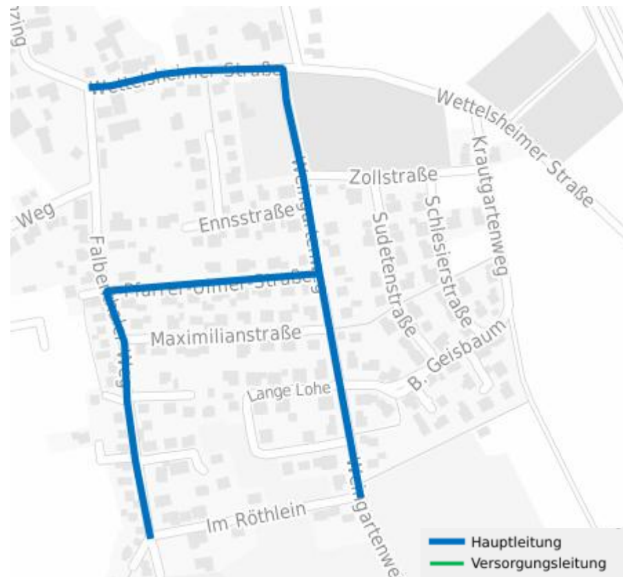
Abbildung 55: Möglicher Wärmenetzverlauf Markt Berolzheim Süd
